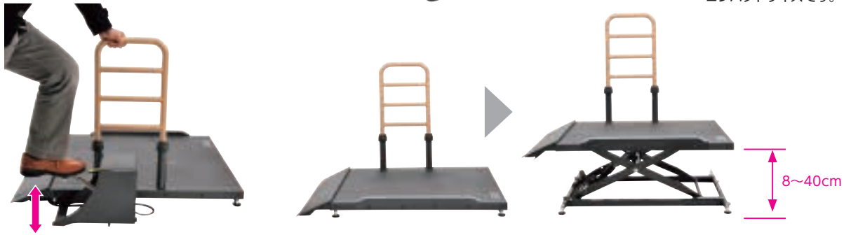
電源不要でフットポンプについているペダルを踏むとテーブルが昇降します。
